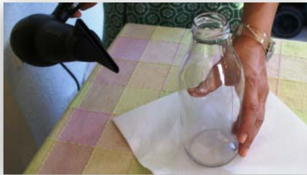
Εικόνα 3. Θέρμανση του αέρα του μπουκαλιού με σεσουάρ. (Φωτογραφία Π. Στεφανίδου).
