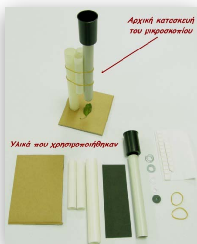
Εικόνα 1. Τα υλικά και η πρώτη εκδοχή του μικροσκοπίου με 2 φακούς. (Φωτογραφία Ν. Τσαγλιώτης).
