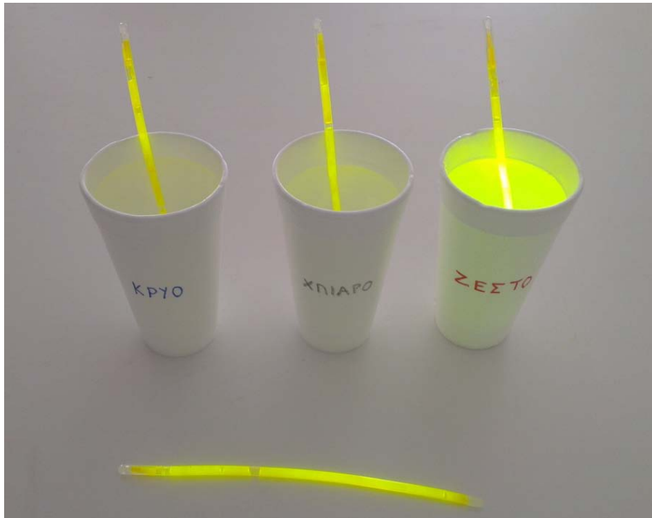
Εικόνα 3. Οι τρεις ράβδοι και η ράβδος αναφοράς (κάτω) μετά από μισό λεπτό παραμονή μέσα σε νερό διαφορετικής θερμοκρασίας. (Φωτογραφία της συγγραφέα).
