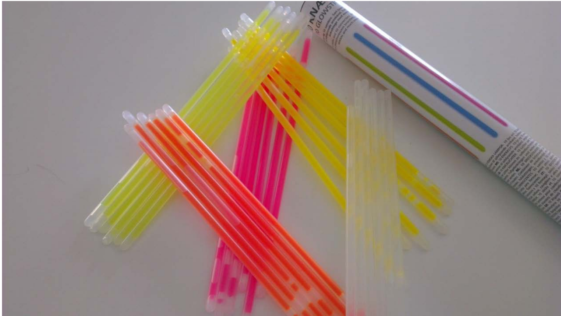
Εικόνα 1. Φωτεινές ράβδοι διαφόρων χρωματισμών πριν την ενεργοποίησή τους. Οι ράβδοι έχουν διαφορετικό χρώμα λόγω των διαφορετικών χρωστικών ουσιών (αρωματικών ενώσεων) που περιέχουν. (Φωτογραφία της συγγραφέα).
