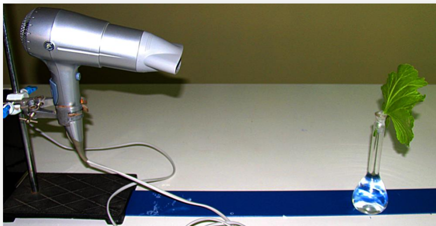
Εικόνα 2. Τοποθετούμε τη φιάλη σε απόσταση 40 cm από το σεσουάρ, ώστε ο αέρας να χτυπά την κάτω επιφάνεια του φύλλου.
