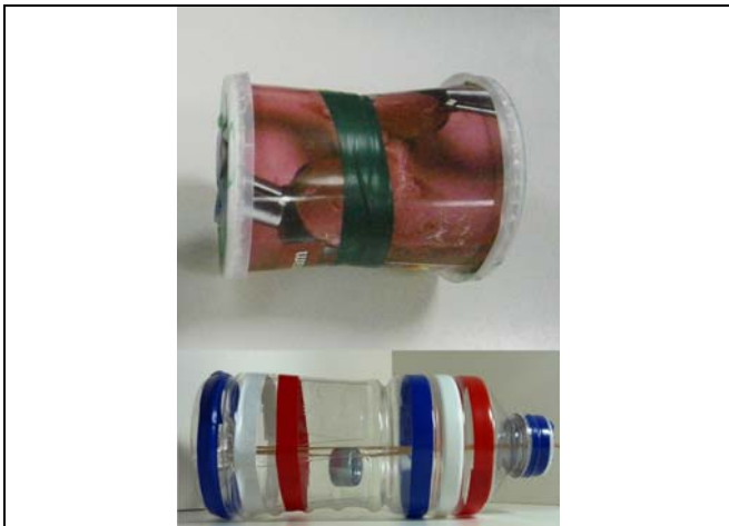
Εικ. 7: Ο «πηγαινοεργάκιας» από 2 κυπελάκια με καπάκι, ή ένα μπουκάλι, μέσα στο οποίο υπάρχει ένα λάστιχο με δεμένο ένα βαρίδι (περικόχλιο) στη μέση του, που στερεώνεται με συνδετήρες ή οδοντογλυφίδες στα άκρα.
