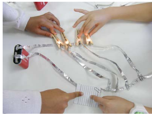
Εικ. 24: Σύνδεση λαμπτήρων παράλληλα με τέσσερα λαμπάκια και κλειστό τσακιστό διακόπτη και όλα να φωτοβολούν.
