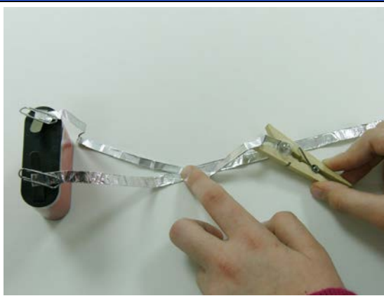
Εικ. 11: Τα αλουμινοκαλώδια ακουμπούν μεταξύ τους και έχουμε βραχυκύκλωμα, το λαμπάκι δεν ανάβει.
