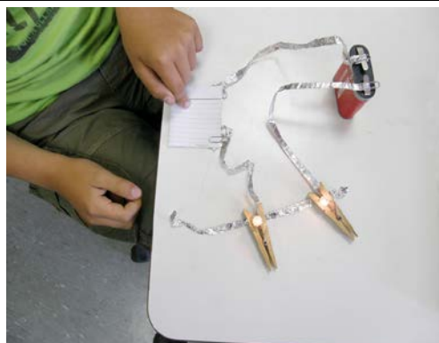
Εικ. 18: Σύνδεση λαμπτήρων στη σειρά με τα δύο λαμπάκια να ακουμπούν πάνω σε άλλο καλώδιο.
