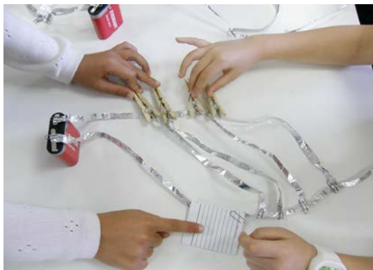
Εικ. 23: Σύνδεση λαμπτήρων παράλληλα με τέσσερα λαμπάκια και τσακιστό διακόπτη, συνεργασία 2 παιδιών με τα υλικά τους.
