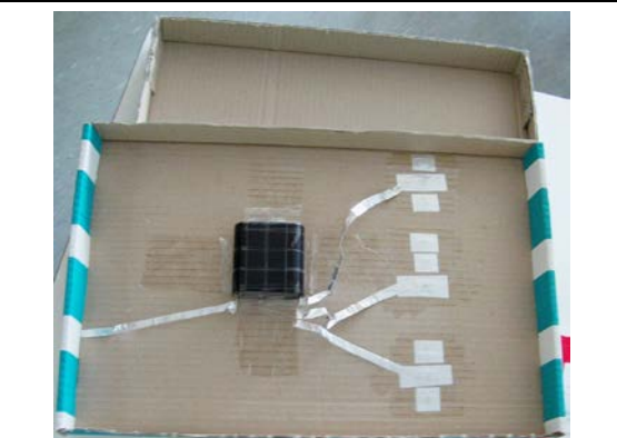
Εικ. 32: Το πίσω μέρος ενός φωτεινού παντογνώστη με 3 ερωτήσεις των 3 εναλλακτικών απαντήσεων και τις αντίστοιχες συνδέσεις τους.
