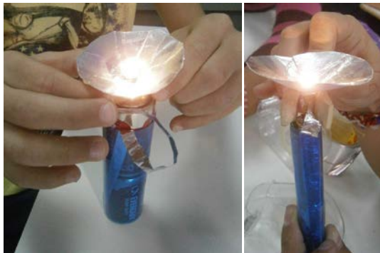
Εικ. 25: Αυτοσχέδιοι φακοί με 2 μπαταρίες τυλιγμένες με ζελατίνη, λαμπάκι, αλουμινοκαλώδιο, και ανακλαστική επιφάνεια.
