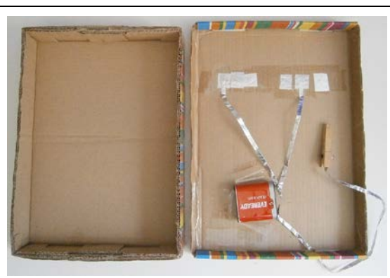
Εικ. 30: Το πίσω μέρος ενός φωτεινού παντογνώστη με 2 ερωτήσεις των 3 εναλλακτικών απαντήσεων και τις αντίστοιχες συνδέσεις τους.
