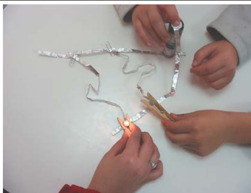
Εικ. 22: Στην παράλληλη σύνδεση τα δύο λαμπάκια έχουν τα "δικά τους" κυκλώματα με το ένα να φωτοβολεί, ανεξάρτητα του άλλου.
