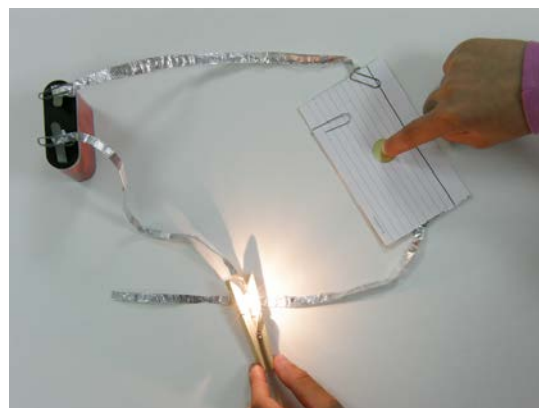
Εικ. 16: Ένα απλό κύκλωμα με "διακόπτη μπουτόν", συνδυασμός 3 καρτελών σημειώσεων & αλουμινοταινία (κλειστό κύκλωμα).
