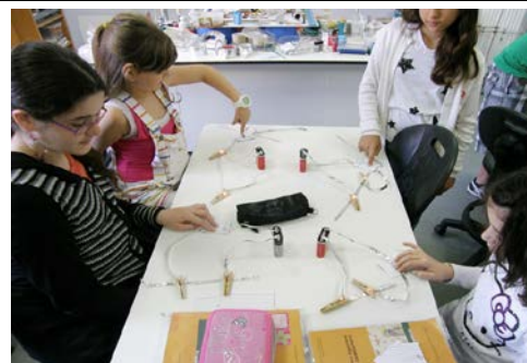
Εικ. 20: Συνδέσεις λαμπτήρων στη σειρά, με μια ομάδα παιδιών στο Εργαστήριο ΦΕ.
