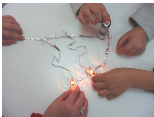
Εικ. 21: Σύνδεση λαμπτήρων παράλληλα με δύο λαμπάκια πάνω σε διαφορετικά αλουμινοκαλώδια και άλλους κλάδους του κυκλώματος.
